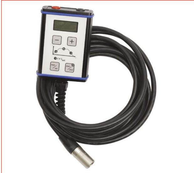
La télécommande comporte la plupart des fonctionnalités du MJÖLNER telles que la mise en marche et l'arrêt, le réglage du courant de test et la lecture des valeurs de test.
